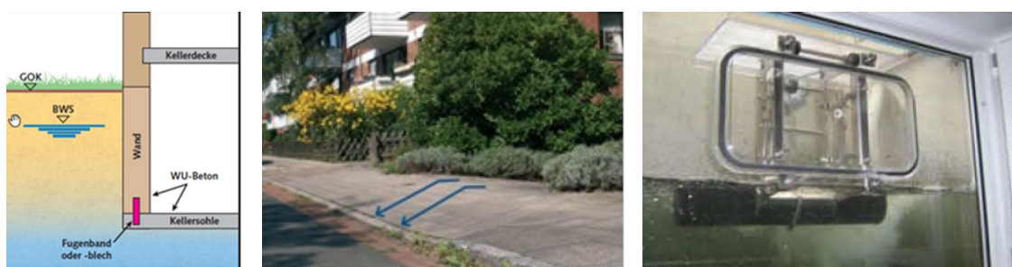
Abbildung 3-11: Maßnahmenbeispiele: Weiße Wanne (Quelle: Hamburg Wasser 3 ), Bodenschwelle vor Tiefgarageneinfahrt (Quelle: SUBV 4 ) und selbstständig schließendes druckwasserdichtes Fenster (Quelle: DWA T1 5 )
