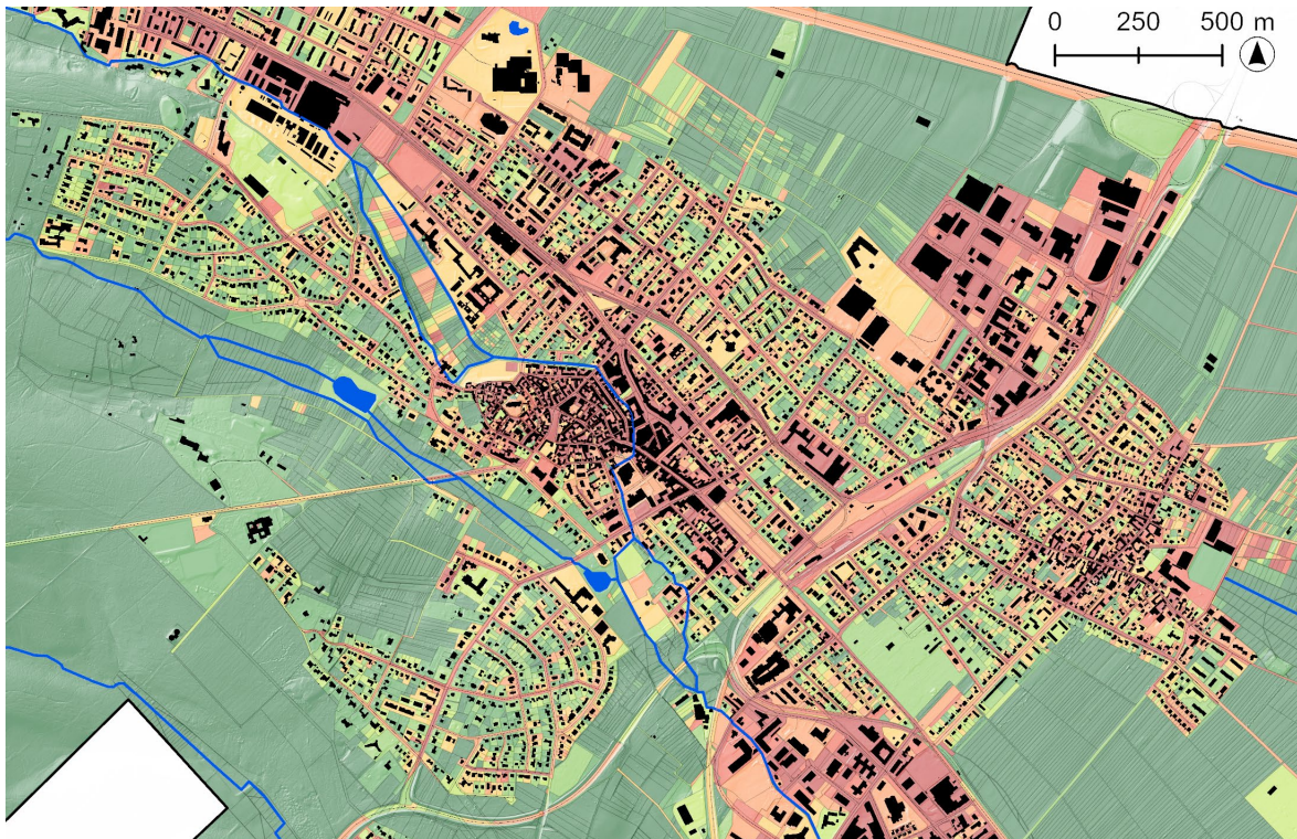
Abbildung 2: Auszug aus der Themenkarte „Flächendurchgrünung“ für den zentralen Bereich der Stadt Oberursel. Die vitalen Vegetationsstrukturen wurden auf Grundlage aktueller digitaler Orthophotos bei einer räumlichen Auflösung von 20 cm identifiziert und für die Flurstücksebene als Bezugsgröße analysiert. Flurstücke mit einem Vegetationsanteil von 10 % und weniger werden in Rot dargestellt, Flurstücke ab über 50 % Vegetationsanteil in unterschiedlichen Grüntönen.
