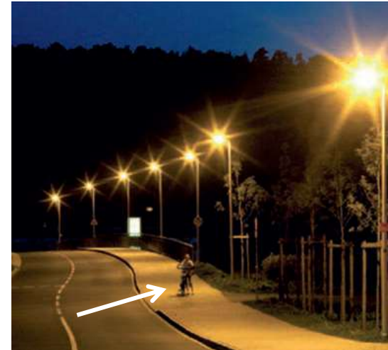
Beleuchtungssituation mit schlechter und guter Gleichmäßigkeit (mit Tarnzone) © Trilux
