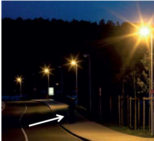
Beleuchtungssituation mit schlechter und guter Gleichmäßigkeit (mit Tarnzone) © Trilux
